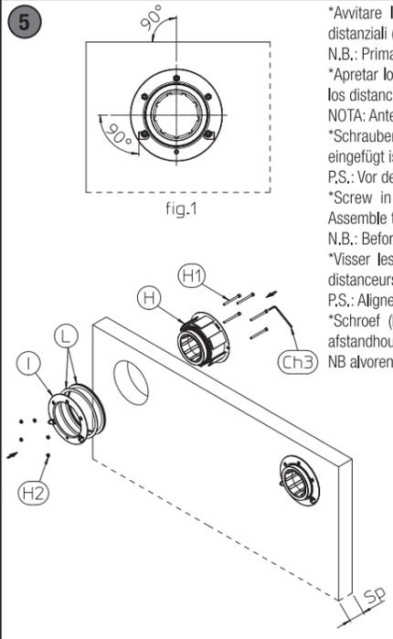
**5** \*Avvitare le viti (H1) sul dado (H2) inserito sulla piastra (I). Montare i distanziali (L) a seconda dello spessore (Sp).
