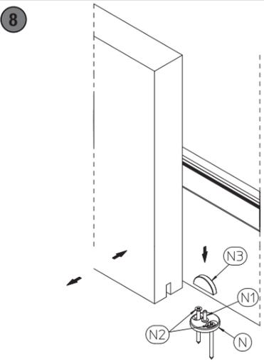
**8** \*Posizionare l'anta a piombo e fissare la guida inferiore (N) con le viti (N2).
