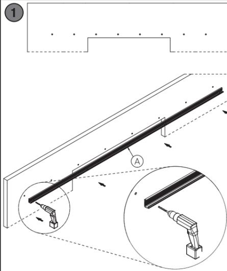
**1** \*Eseguire le forature per tasselli adeguati al tipo di muro. Utilizzare il binario come maschera di foratura. In funzione della lunghezza del binario varia il numero di forature.
