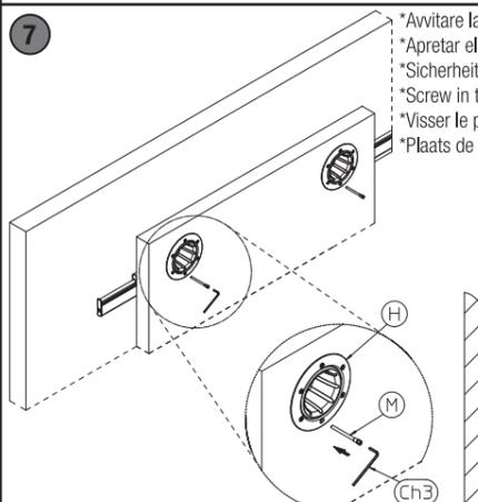
**7** \*Avvitare la vite di sicurezza (M) sul carrello (H).
