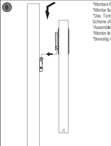
**6** \*Montare l'anta appoggiando le ruote del carrello (G) sopra il binario (A).
