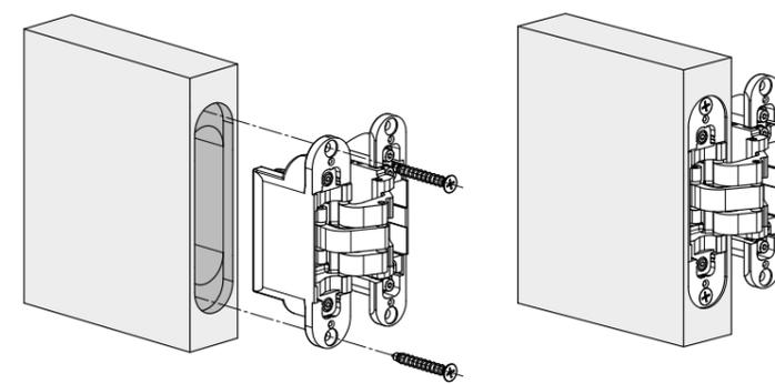
IT - Inserire la parte delle cerniere marchiata "door" (profondità 53 mm) nelle fresate dell'anta avendo cura di scegliere il corretto verso di apertura, fissare quindi le cerniere avvitando le appropriate viti da legno.
