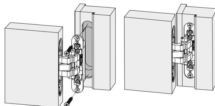
IT - Montare l'anta sullo stipite inserendo la parte telaio delle cerniere (profondità 31 mm) nelle apposite fresate, fissare quindi le cerniere avvitando le appropriate viti da legno.
