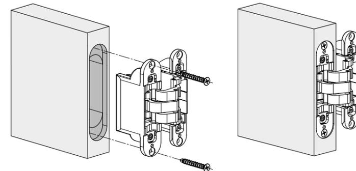
**ES -** Introduzca la parte de las bisagras marcadas "door" (profundidad 53 mm) en las ranuras de la puerta, eligiendo con atención el correcto sentido de apertura, luego fíjelas enroscando los específicos tornillos para madera.
