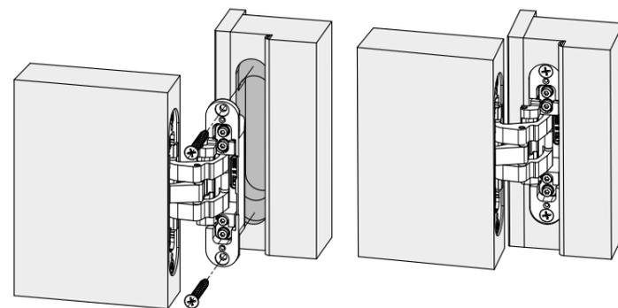
**ES -** Monte la puerta sobre el pilar, introduciendo la parte marco de las bisagras (profundidad 31 mm) en las ranuras correspondientes, luego fíjelas enroscando los tornillos específicos.
