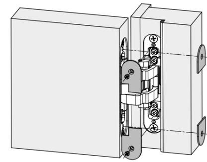
IT - Applicare i cappucci, utilizzando le apposite viti fornite a corredo.
