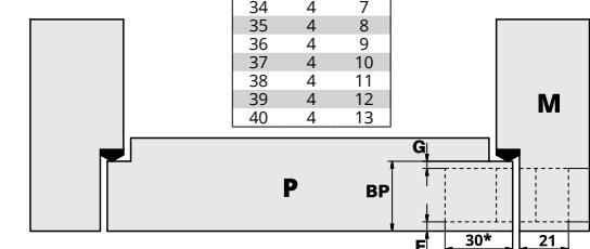
\*ES - El mecanizado realizado según el esquema ilustrado, sirven para volver compatible la bisagra IN232 con los modelos IN230 y IN235.
