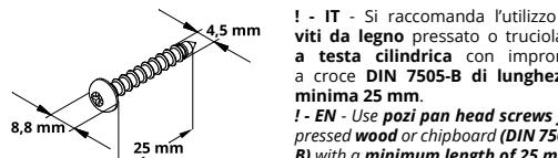
**! - IT** - Si raccomanda l'utilizzo di viti da legno pressato o truciolare a testa cilindrica con impronta a croce DIN 7505-B di lunghezza minima 25 mm.
