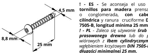
! - ES - Se aconseja el uso de tornillos para madera prensada o conglomerada, con cabeza cilíndrica y ranura cruciforme DIN 7505-B, longitud mínima 25 mm.
