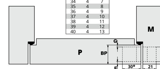
**IT** - Le fresate realizzate come da schema sopra riportato servono a rendere compatibile la cerniera IN232 con i modelli IN230 e IN235.
