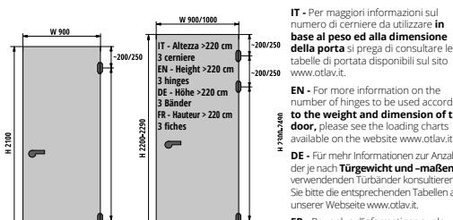
**IT** - La porta, una volta installata, subisce un naturale calo. Le cerniere IN232, se installate correttamente, grazie alla differenza di realizzazione tra il modello "A" ed il modello "B", permettono di riportare l'anta nella posizione ottimale.
