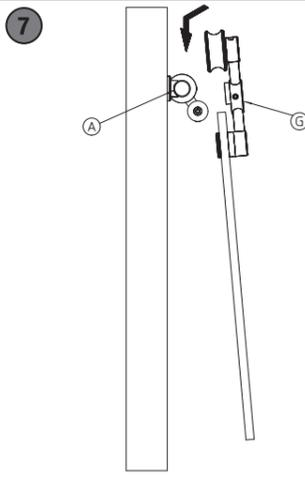
**7** \*Inclinare leggermente l'anta ed appoggiare le ruote del carrello (G) sopra il binario (A). N.B.: Fare molta attenzione nel movimentare l'anta.
