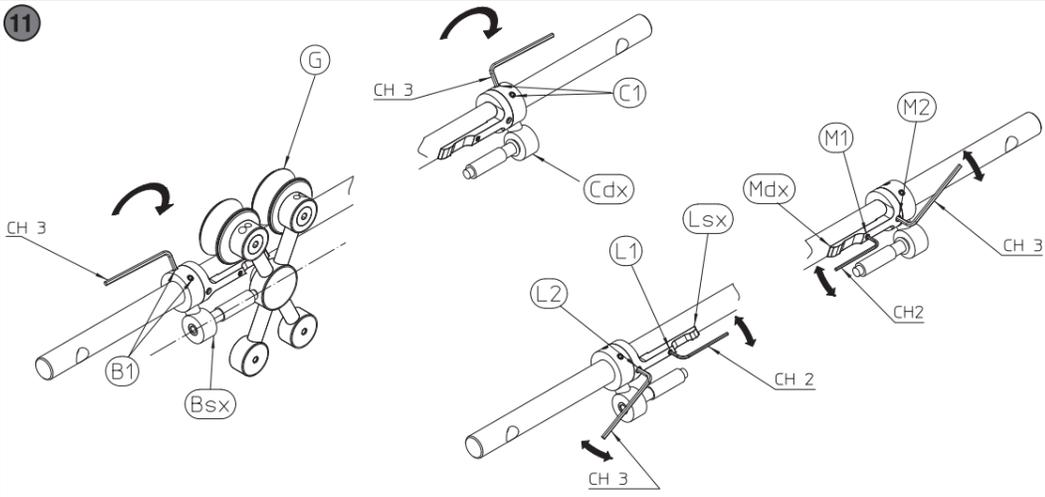
**11** \*Regolare i freni (Bsx e Cdx) in asse con il carrello (G). Fissare i freni (Bsx e Cdx) avvitando i grani (B1 e C1), mediante chiave esagonale CH3. Fissare i blocchi (Lsx e Mdx), avvitando i grani (L2 e M2), mediante chiave esagonale CH3. Regolare forza di bloccaggio agendo sui grani (L1 e M1), mediante chiave esagonale CH2.
