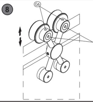
**8** \*Ruotare l'eccentrico delle ruote (G7) fino a portare in bolla l'anta rispetto al piano. Serrare l'eccentrico (G7) tramite i grani (G6).
