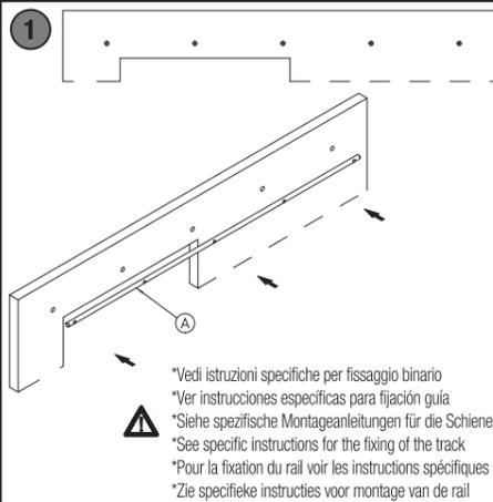
**1** \*Eseguire le forature per tasselli adeguati al tipo di muro. Utilizzare il binario come maschera di foratura. In funzione della lunghezza del binario varia il numero di forature.
