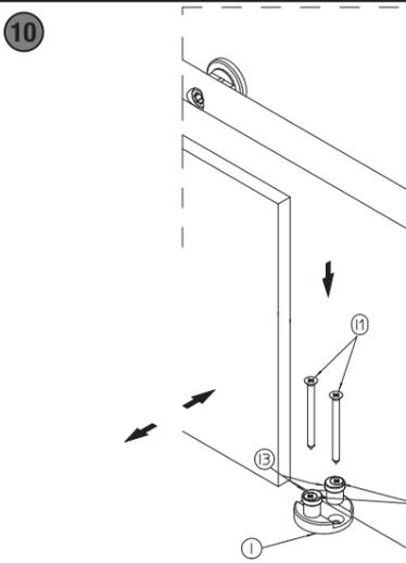
**10** \*Posizionare l'anta a piombo e fissare la guida inferiore (I) con le viti (I1). Regolare l'oscillazione dell'anta allentando le viti (I2), ruotare gli eccentrici (I3) e serrare le viti (I2).
