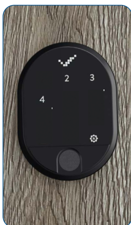
Gdy na wyświetlaczu pojawi się symbol V oznacza to, że dane hasło użytkownika zostało usunięte. Następnie urządzenie wyłącza się automatycznie
