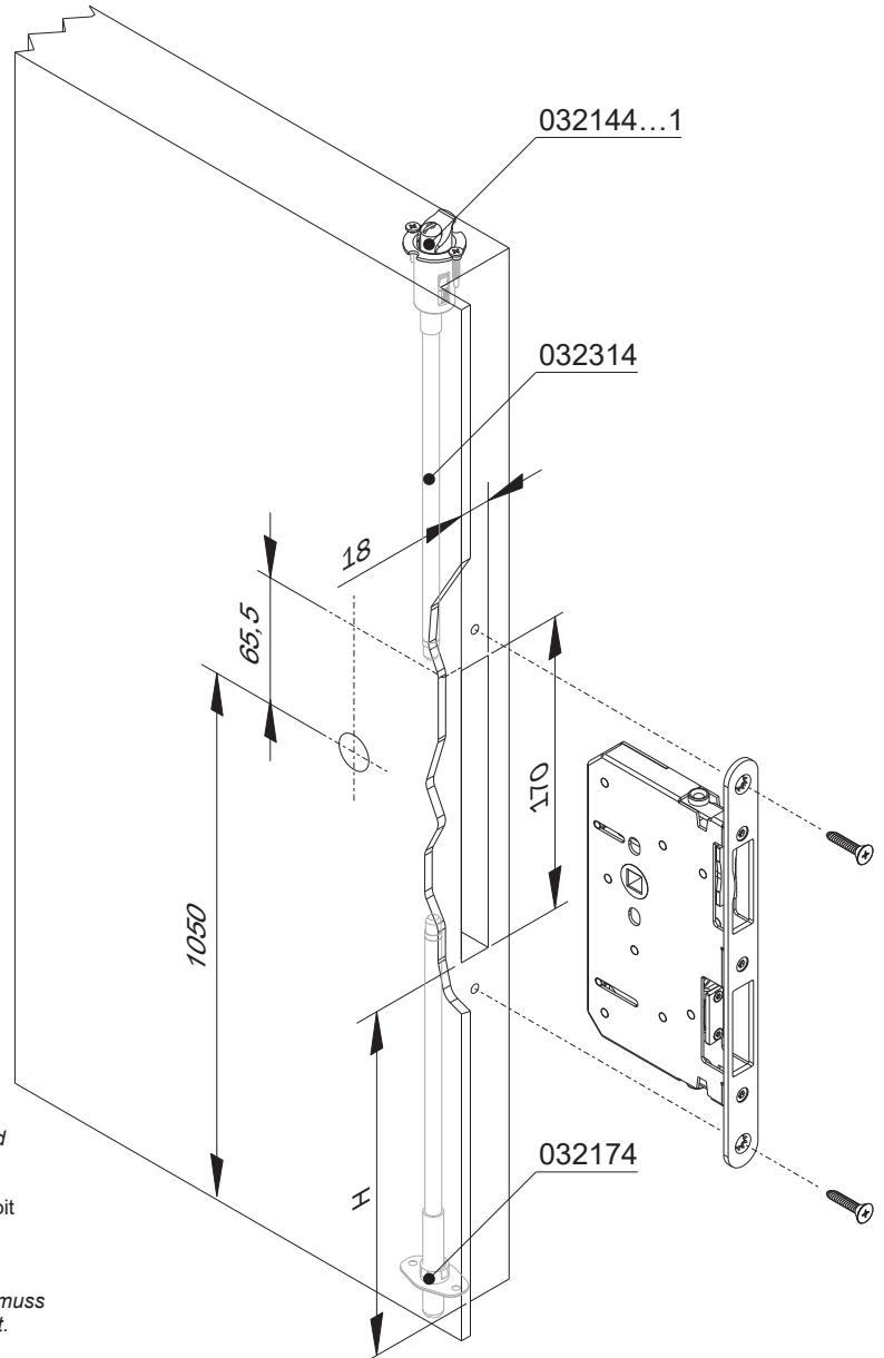
Nel caso di porta a due ante, la quota H è strettamente legata al posizionamento della serratura sull'anta principale. La contro serratura deve essere posizionato in modo che la cava dello scrocco sia centrata con lo scrocco stesso.
